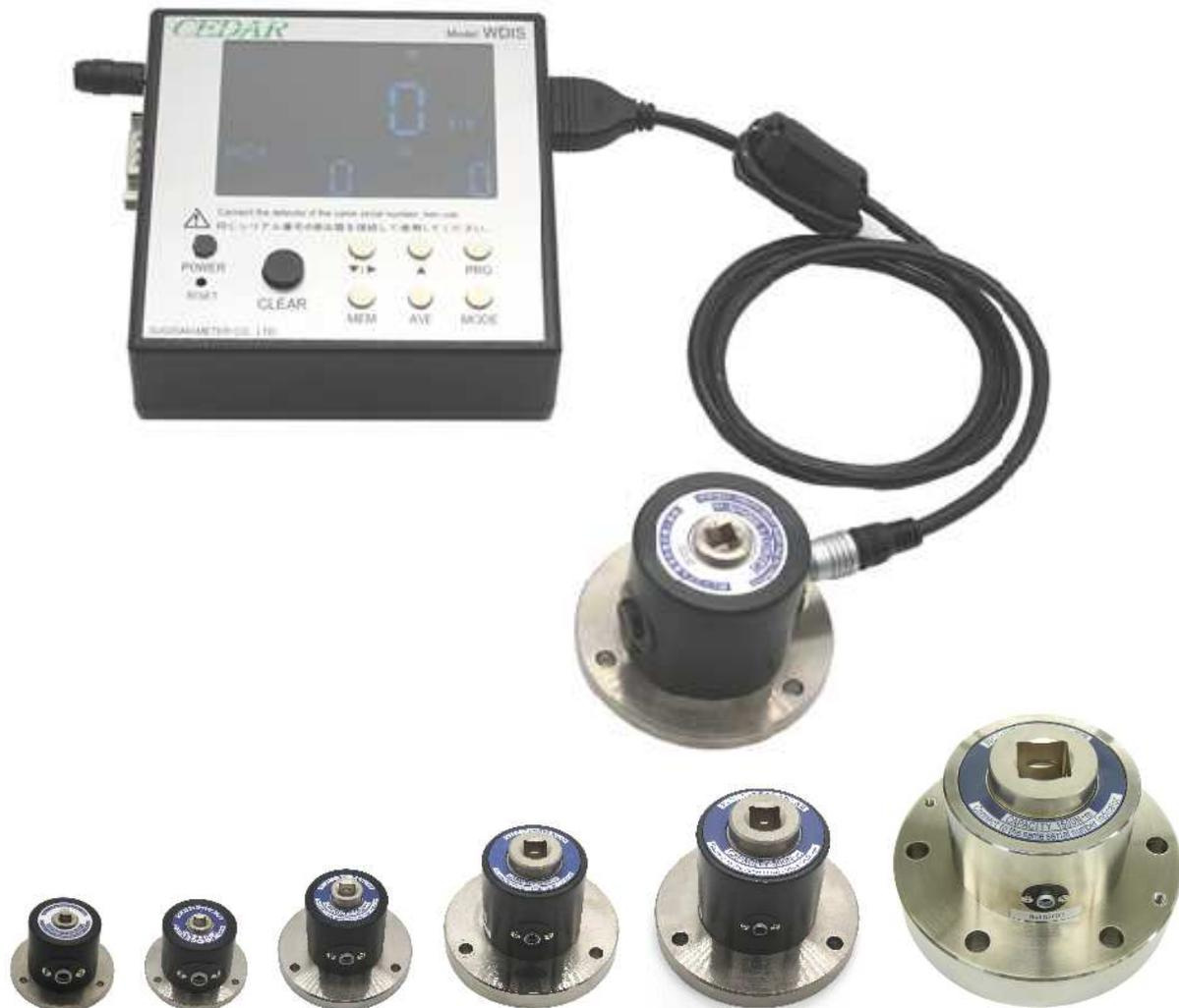
パソコンや PLC と連動して、トルク測定をより高度に管理します。
