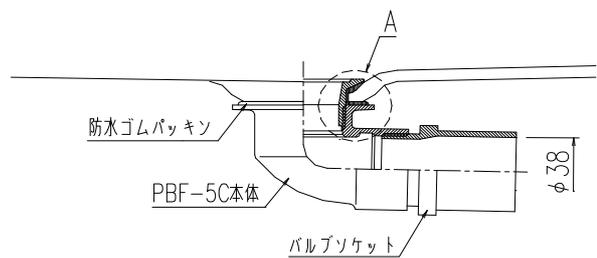
バルブソケットが浴槽脚よりも下になる場合があります。浴槽脚の土台高さを調整し、床面と排水金具が干渉しないようにしてください。
