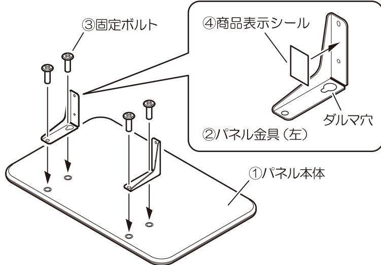
2. ①パネル本体に②パネル金具を③固定ボルトで取付けてください。
