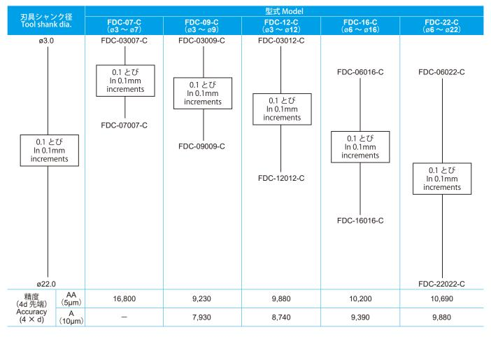
クーラントコレットの縮み代は 0.1mm です。 Coolant collets collapse by 0.1mm.
