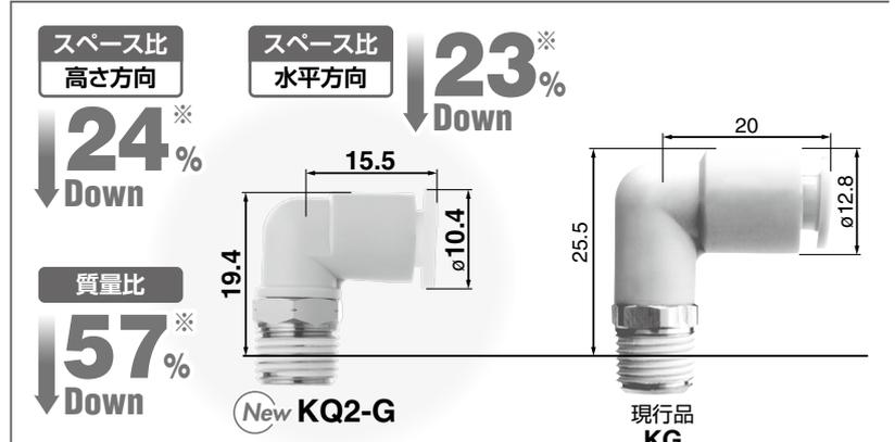
※現行品KGシリーズ エルボユニオン/適用チューブ外径:φ6/接続ねじ:R1/8の場合
