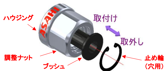
図7 止め輪脱着図
