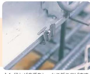
14. 段セバの爪をしっかり折り曲げます。
