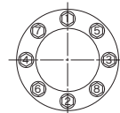
図2 クランプねじ締付け順序
