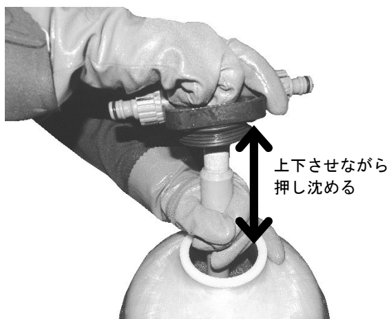
図：集水管を押し沈めているところ
