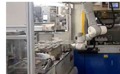
半導体パッケージ材料の ロード/アンロード
