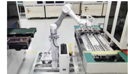
電池コアの溶接の ローディングとアンローディング
