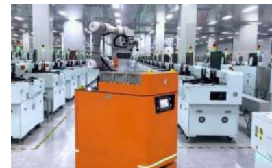
ダイボンディングマシンの ローディングとアンローディング
