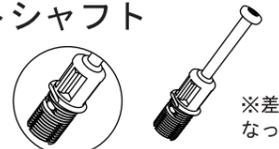
ジョイントシャフトを指定の板面穴に差し込みます。隙間が無いように最後まで差し込んでください。
