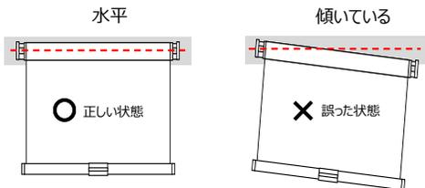
※ 製品は水平に取付けてください、斜めに取付けるとスクリーン巻きずれを起こし、故障の原因になります。
