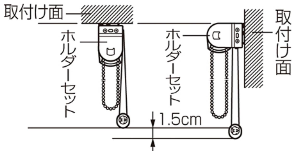
製品高さは、ホルダーセットの上面からウエイトバーキャップの下部までの長さになります。天井付けで高さ指定した製品を正面付けにすると、製品高さが1.5cm長くなります。
