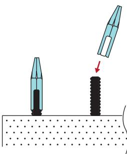
2 基礎アンカーボルトにアンカーボルトガイドキャップをはめ込みます
