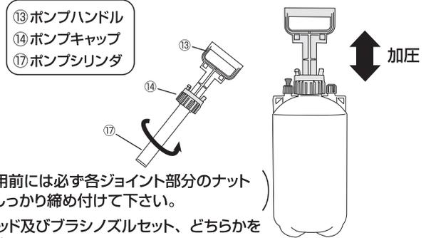
**注意** 加圧するときは、必ずホースセット⑥のカップリングに⑤シャワーヘッド及びブラシノズルセット、どちらかをセットしてから圧力をかけて下さい。セットしないと、⑥から水が飛散します。
