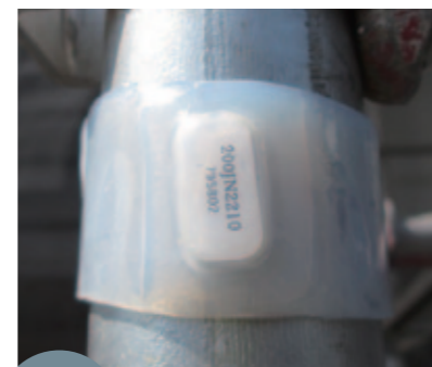
その他 Other 工具等へのRFID固定 RFID fastening to tools, etc.crack
