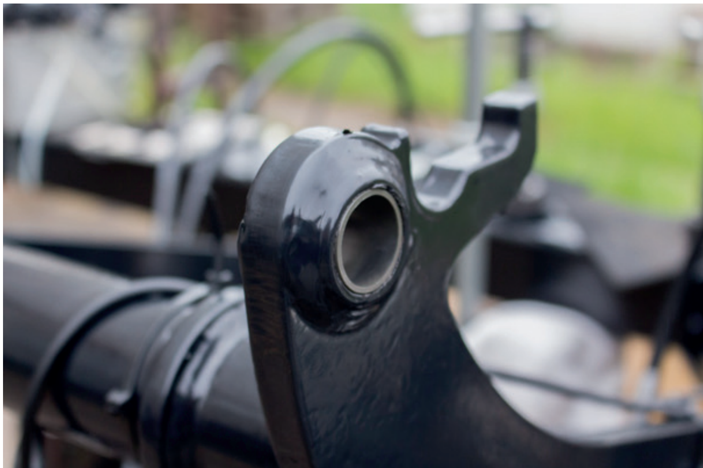
すべり軸受を圧入した時のベアリングの位置
