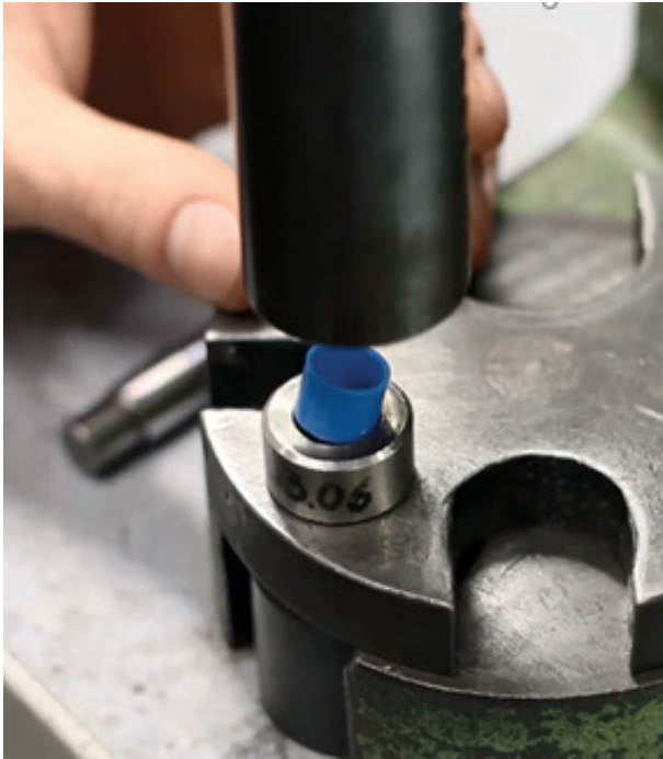
挿入されたプラスチック製ブッシュに圧入
