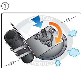
① ライトを治具に取り付けた状態で、吸盤をガラス面に取り付けます。
