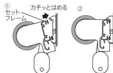
セットフレームの下側をブラケットに差し込み、さらに上側をはめ込みます。
