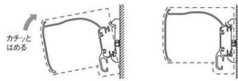
カバーの下側をブラケットに差し込み、さらに上側をはめ込みます。
