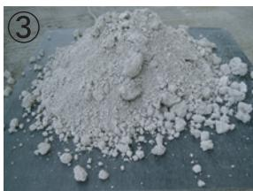
約3分程度の攪拌で、水性塗料が固化し、パラパラの状態になります。
