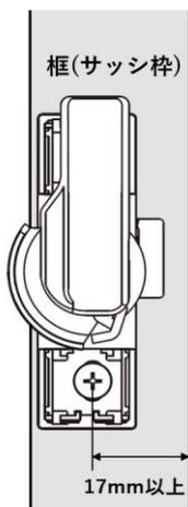
現在取付いているクレセントのねじ中心から室内方向に17mm以上の取付面がないと部品がはみ出してしまい交換できない場合があります。
