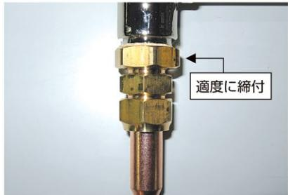
パッキンナットをスパナで適度に締め付けします。強く締め過ぎると火口先の芯ズレが発生しますので注意して下さい。
