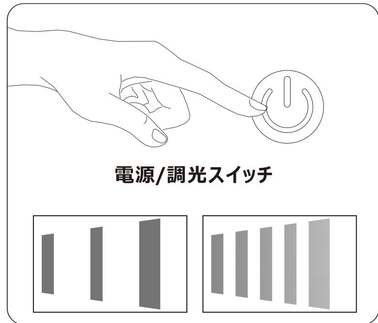
電源ボタンで、ON/OFFと点灯モードを切り替える事が出来ます。
