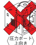
②付属のM3ビス(長さ8mm)を使用して、本製品をセンサ(M3めねじ)に取り付けます。その際の締め付けトルクは、0.5N・m以下としてください。
