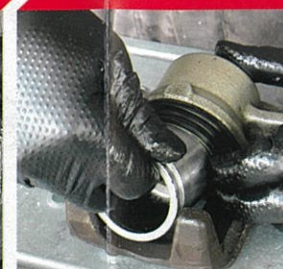
ピストンを挿入 (キャリパー内で少し押し込む)
