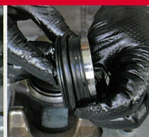
キャリパーピストンインストーラーをダストブーツに取り付ける
