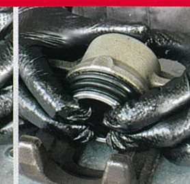
キャリパーピストンインストーラーを外し、ピストンを奥まで挿入
