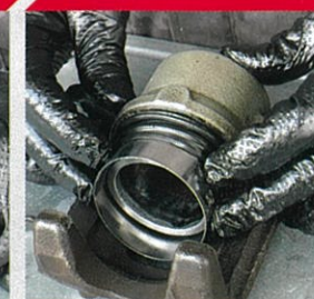
キャリパーピストンインストーラーを外し、ピストンを奥まで挿入
