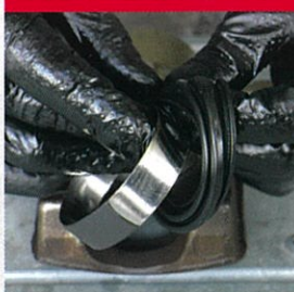
キャリパーピストンインストーラーをダストブーツに取り付ける
