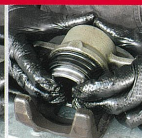
ピストンを挿入 (キャリパー内で少し押し込む)
