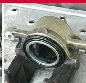
キャリパーピストンインストーラーを外し、ピストンを奥まで挿入
