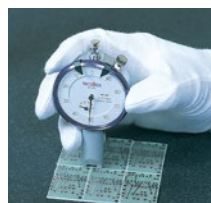
DM-251を用いた プリント基板の溝の深さ測定
