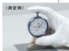
塗膜防水材の厚さ測定（加圧して測定します）
