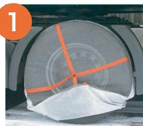
タイヤ（駆動輪）の設置部以外に被せ、車をタイヤ半回転分移動させる。
