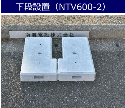
下段設置 (NTV600-2) 耐震クラスSを必要とされる場合はΦ20 の穴2ヶ所にアンカー施工をしてください
