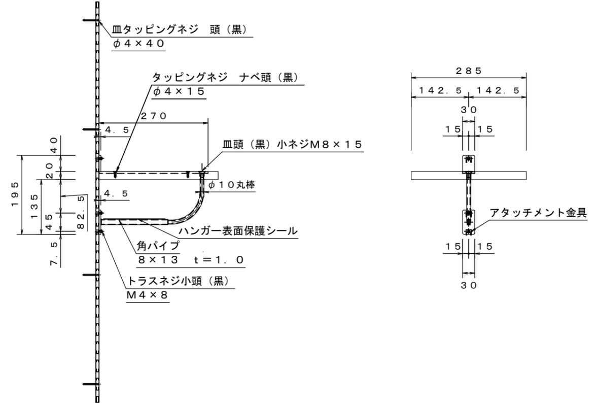
1. 壁面に棚レールを同梱のタッピングネジφ4×40で固定してください。壁裏下地に合わせて適切な位置に取り付けてください。
