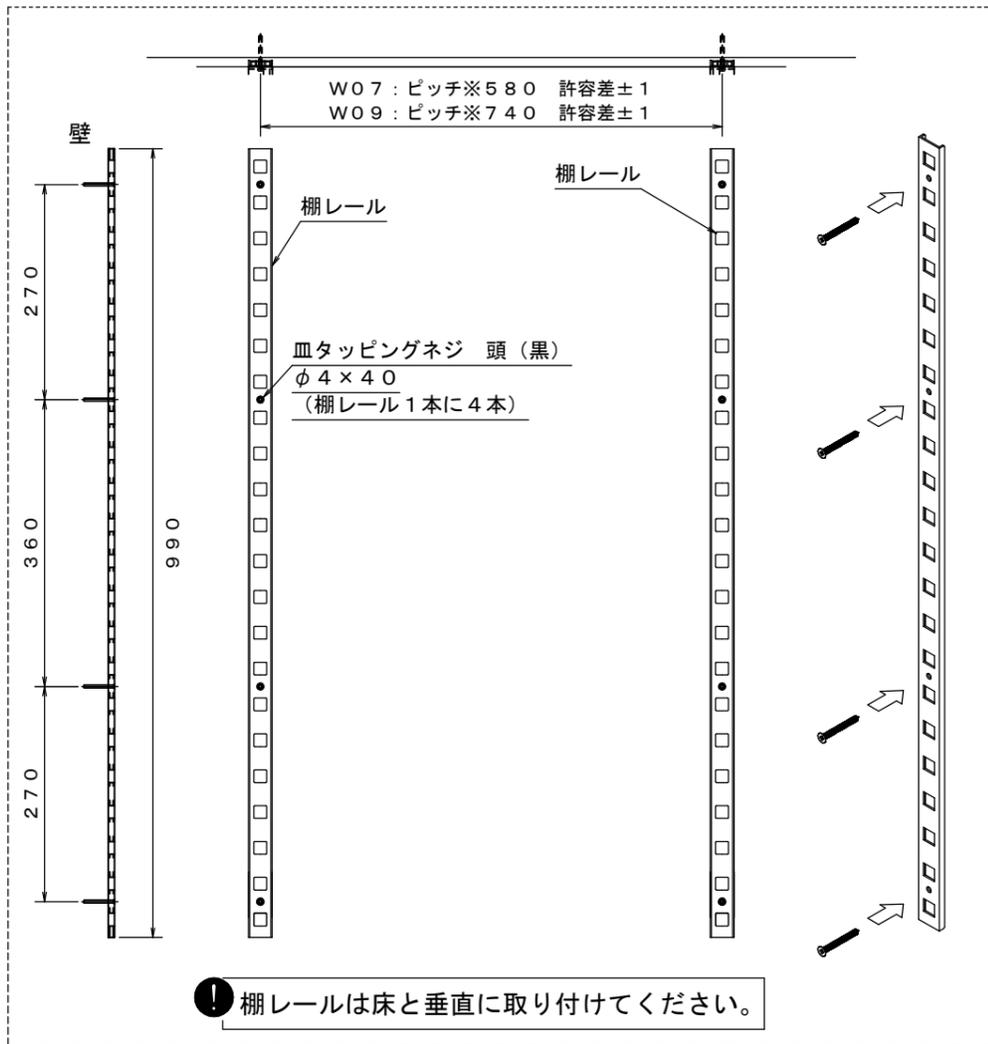
石膏ボード裏面に t 12mm合板下地もしくは間柱があることを確認して下さい。
