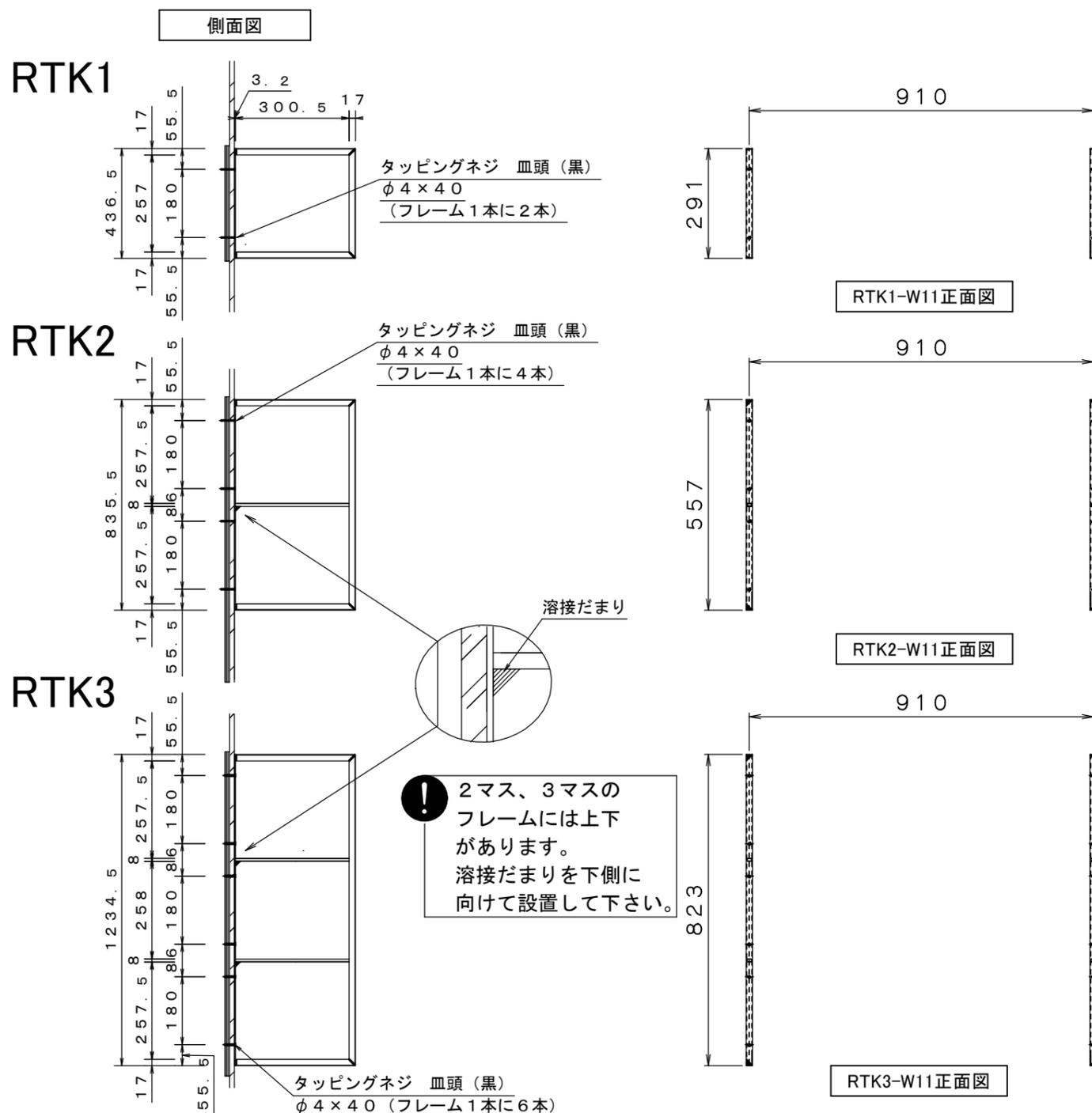
2. 棚板（下穴なし）と鉄フレーム部を棚固定金具を使用して同梱ネジにて連結してください。
