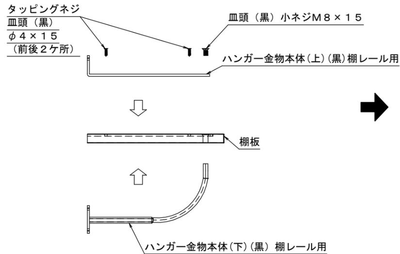
3. ハンガー金物本体、差込みワッシャー、アタッチメント金具をトラスネジを下図を参考にドライバーで取り付けます。アタッチメント金具の上下方向は間違えないように御注意してください。
