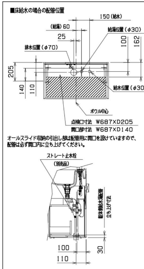
オールスライド収納の引出し部は配管用に開口を設けていますので、配管は必ず開口内に立ち上げてください。
