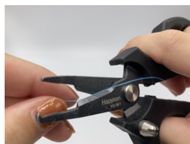
PEラインカッター 刃の幅が長くギザ刃で切れやすい
