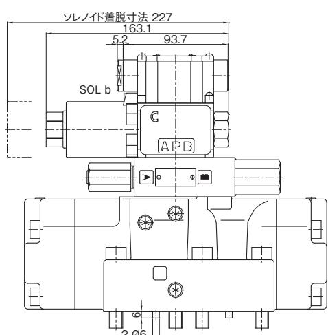
注)この電磁バイロット切換弁にはサージ圧力が入らないようにして使用してください。
