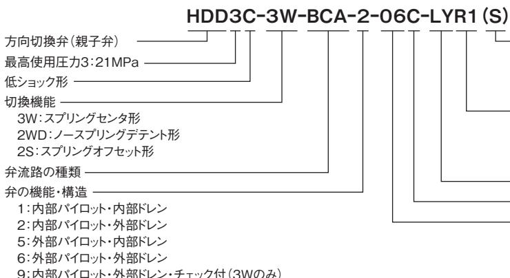
この弁は電磁切換弁と低ショック機能を持たせた油圧切換弁を結合した切換弁で、大流量の切換時のショック、振動、騒音、サージ圧を防止します。
