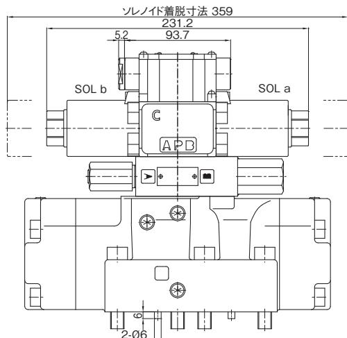
注)この電磁バイロット切換弁にはサージ圧力が入らないようにして使用してください。
