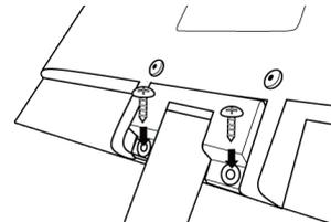
④支柱の穴が開いた方をモニター側にして、モニターの支柱部分に差し込みます。確実にはまり、スタンドが回らないことをご確認ください。
