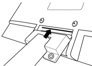
③ネジ穴 2 箇所付属のネジ 2 本を挿入しドライバーで回して固定します
