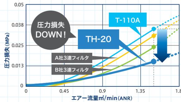
※1 フィルター最大流量 (1500ℓ/min)、供給圧力0.6MPa時
