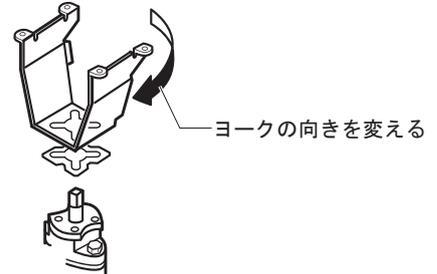
(6) 手順 (3) で外した特殊シートをヨークとバルブの間に元ようにはさみ、ねじで、ヨークをバルブに取り付けます。
