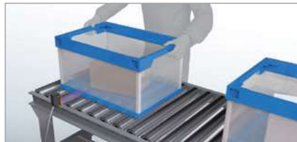
検品・ピッキングライン 作業者を検出せずに、検出体のみ安定検出。
