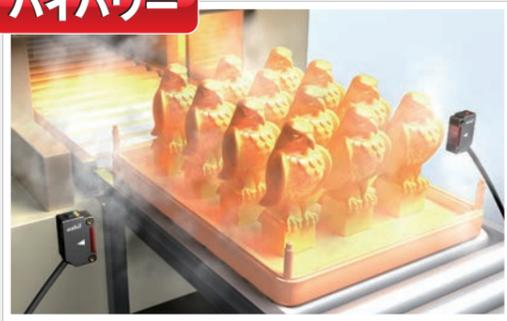
埃やけむりなど雰囲気の良い炉の出入口の通過検出に。30mの検出距離により長期使用が可能です。
