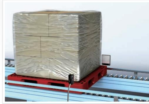
リフレクタ形を誤動作させるラッピングフィルムで巻かれたワークや半透明オリコンなど偏光を乱す物体を安定検出します。
