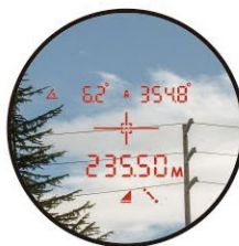
間隔ライン測定： ML + 水平距離 + 傾斜角 + 方位角
