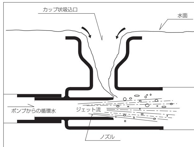
ポンプ吐出し口にバイパスを設け、揚水の一部をポンプ吸込口まで循環させ、ジェット流を発生させます。このジェット流によって起きるエジェクター効果で、回収カップ内（吸込口）に吸引力を発生させます。
