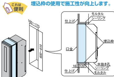
埋込枠の使用で施工性が向上します。
