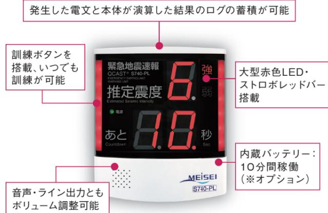
「受信ユニットS740-PL」は自局位置での推定震度と猶予時間、さらに長周期地震動階級予測を表示することができます。情報発信時には、内蔵スピーカーの音声と左右の赤いバー部分の点滅で伝達します。接点出力を用いて各種装置・設備を停止したり、アナログ音声出力を利用して、構内放送などで人々に注意を促すことも可能です。
