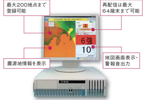
「受信装置S704-FCPL」は「受信ユニットS740-PL」の機能に加え、ディスプレイの地図上に震源・P波とS波の伝達状況をグラフィカルに表示させることが可能です。そのため、他の事業所など複数箇所の推定震度表示やシミュレーション機能で、他地点での推定震度・猶予時間の予測や、普段からの防災対策などに役立ちます。また、再配信数が64端末に強化され、緊急地震速報の共有化を低コストで実現できます。
