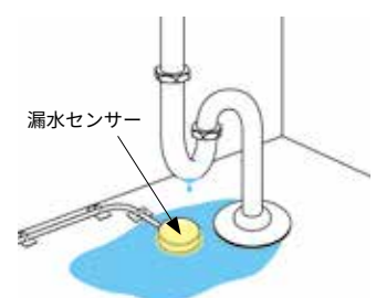
水道周りにポイント漏水センサーを取り付け
