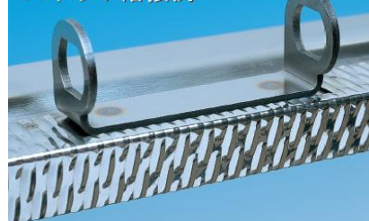
スポット溶接例
