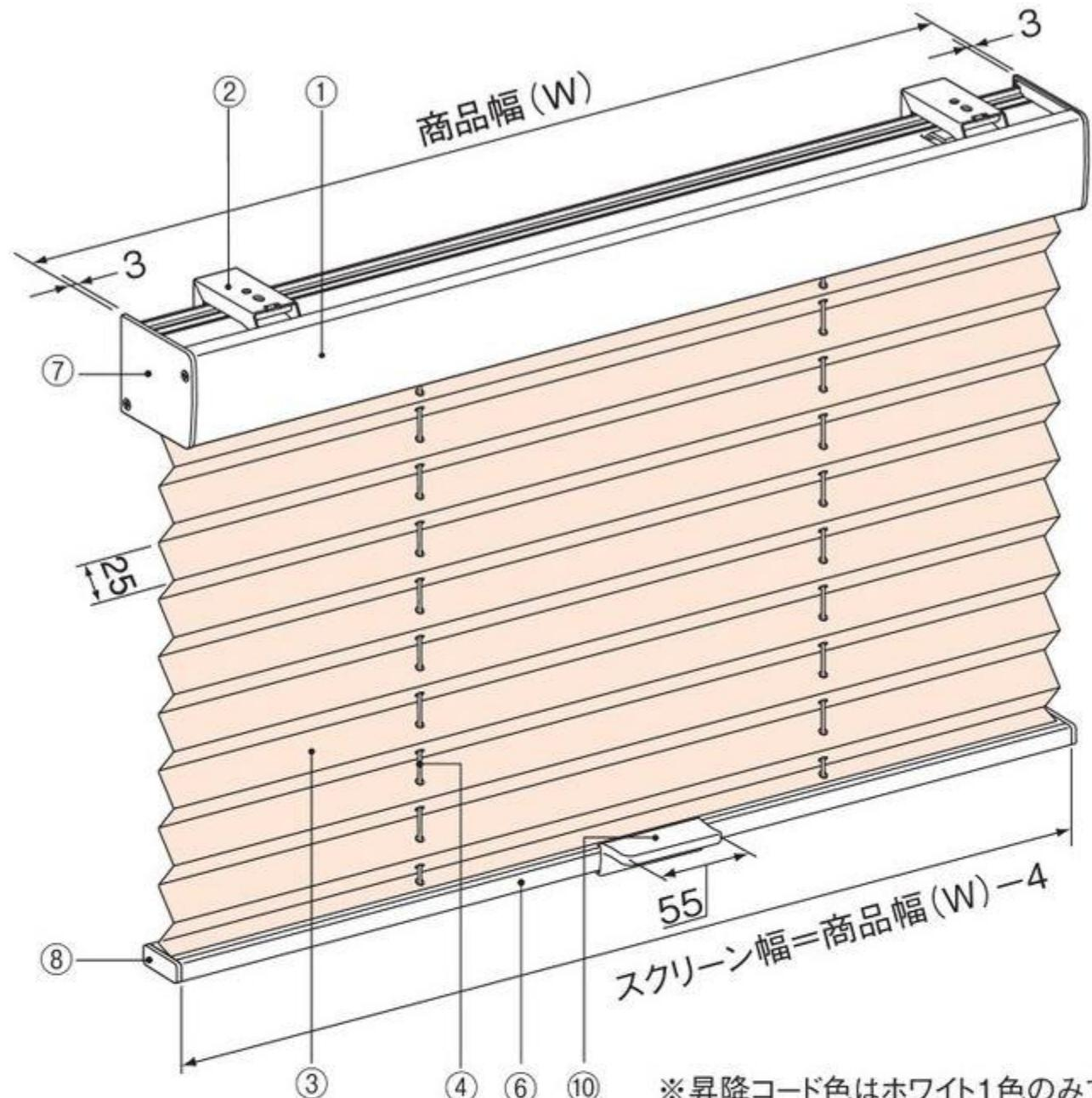
①ヘッドボックス ②ブラケット ③スクリーン ④昇降コード ⑤ピッチテープ ⑥ボトムレール
