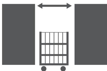
狭い場所を通過する場合、カゴ台車と壁や障害物との間に人が挟まれる事故・器物破損等が起こる恐れがあります。カゴ台車を移動させる際はカゴ台車と人の通過スペースが十分に確保できる経路を設定して下さい。
