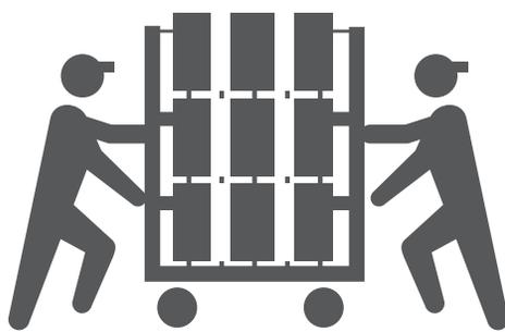
カゴ台車の制御不能による器物や人への衝突事故の恐れがありますので、1度に運搬する重量を制限する・重量物運搬の際は2名以上に作業を行う等して、注意してご使用ください。
