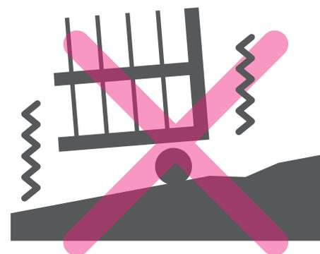
カゴ台車を移動させる際は必ず床や地面に凹凸や傾斜がない経路を設定して下さい。人がカゴ台車・荷物の下敷きになる事故や器物の破損などが起こる恐れがあります。
