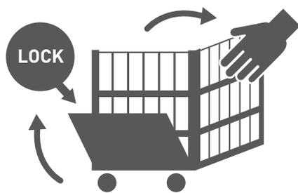
かご台車を折りたたむ時に、底板を跳ね上げたら、必ず底板をストッパーでロックしてください。
