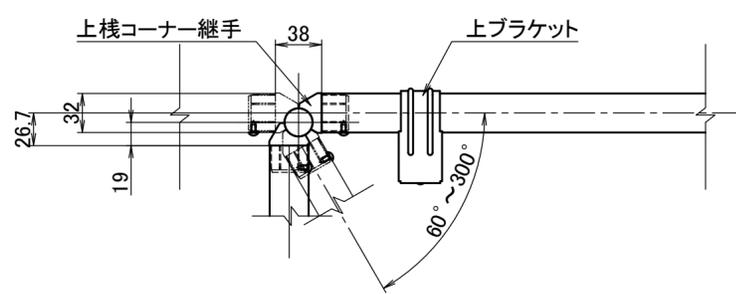
ストレート継手部納り図 S:1/4
