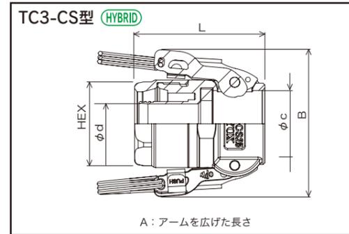
※ 材質 TC3-CS : 本体 (ニップル) : SCS14 (SUS316相当)、カムアーム : SCS14 (SUS316相当)、固定板 : SUS304、リング : SUS304
