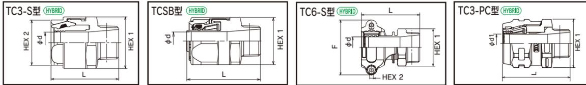
※ 材質 TC3-S：ニップル、袋ナット（SCS13 / SUS304相当）、ゴムパッキン（NBR）、スリーブ（ポリアセタール）
