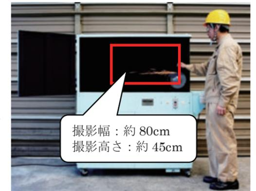
図2 火花発生装置の外観 (標準火花試験ブース 1 型)
