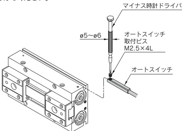
注) オートスイッチ取付ビスを締付ける際には、握り径5~6mm程度の時計ドライバを使用してください。
