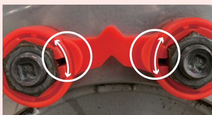
溝の位置が三日月の突起の範囲外なら ボルトが大きく動いたことになります。
