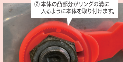
凸部分が溝に引っ掛かり、ボルトの回転を抑制します。
